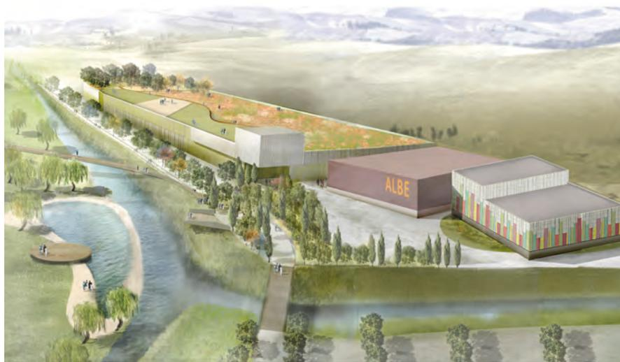
Il progetto prevede la realizzazione di un impianto di trattamento e recupero della frazione organica della raccolta differenziata dei rifiuti urbani (FORSU) per la produzione di compost di qualità da utilizzare in agricoltura e di biometano con caratteristiche idonee all'immissione in rete.
